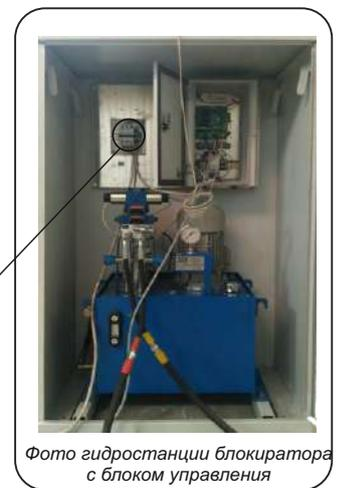
Фото гидростанции блокиратора с блоком управления
